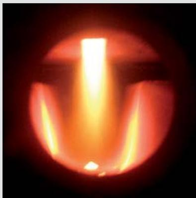
Процесс пиролизного горения в камере сгорания котла Vitoligno 100-S.
